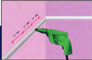
1. กำหนดระดับรอนห้อง และติดตั้งโครงคร่าวริมเข้ากับผนัง
