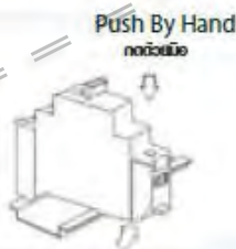
Fixing MCB TO Din Rail การติดตั้งเบรกเกอร์กับรางหลัก
